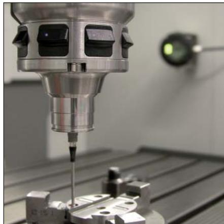
Sistemi di tastatura con **trasmissione del segnale via cavo** per macchine con cambio utensili manuale:
