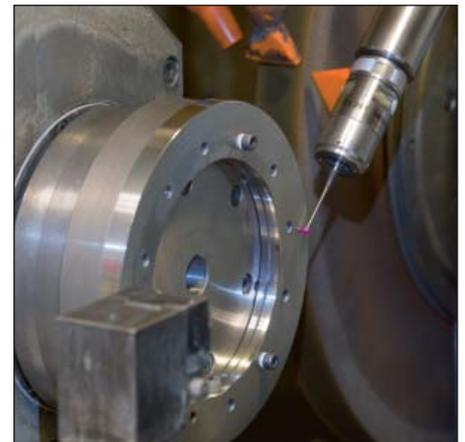
Sistema di tastatura con **trasmissione del segnale via cavo**
