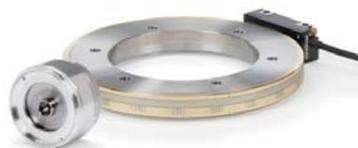
Nei **sistemi di misura angolari e trasduttori rotativi incrementali** la posizione attuale viene determinata, partendo da un'origine definita, mediante conteggio di passi di misura o mediante suddivisione e conteggio di periodi del segnale. Per riprodurre l'origine, i sistemi di misura incrementali di HEIDENHAIN sono dotati di indici di riferimento.
