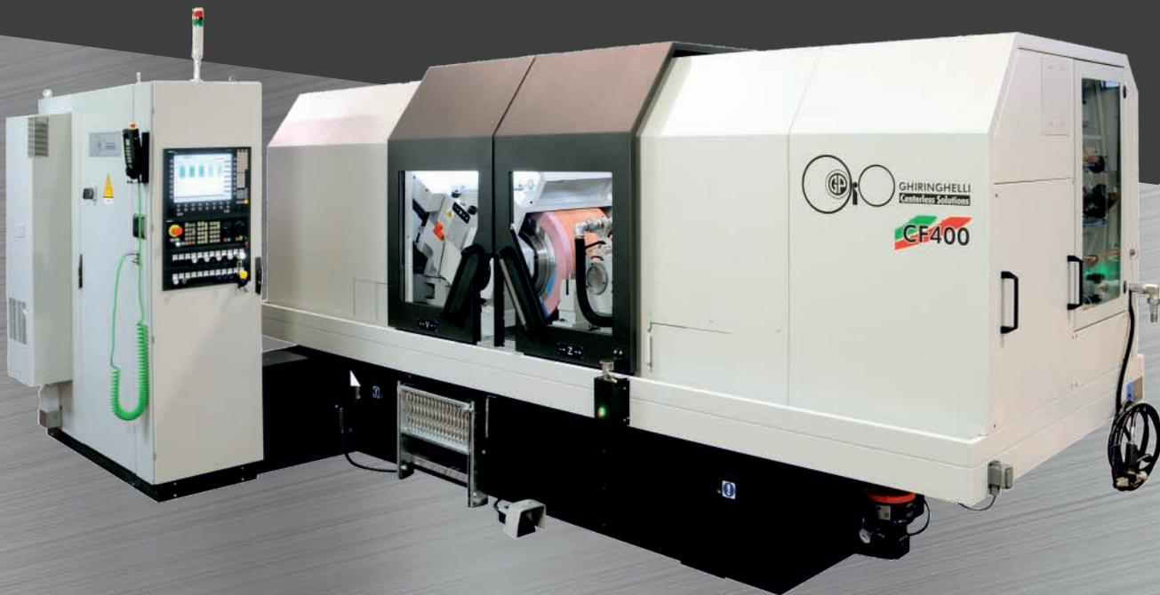
**Serie di rettificatrici senza centri ad alta tecnologia a centro fisso per la lavorazione sia a tuffo che in infilata.**
