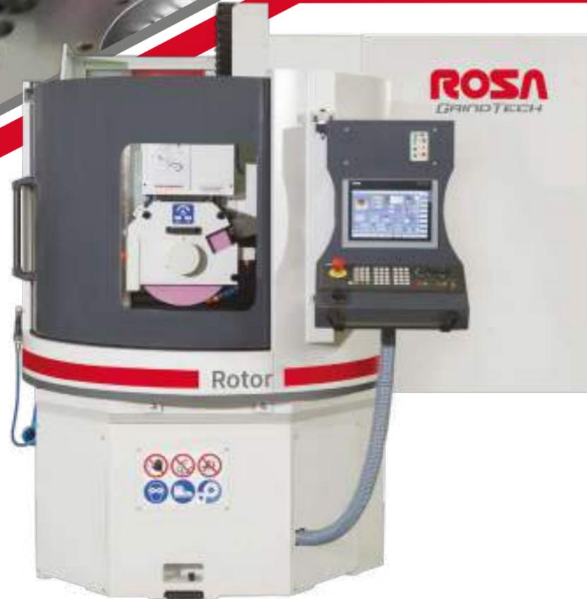
**Dotata di tavola rotante e ciclo di diamantatura automatico, ideale per lavorazioni di particolari circolari in piccole e grandi serie.**
