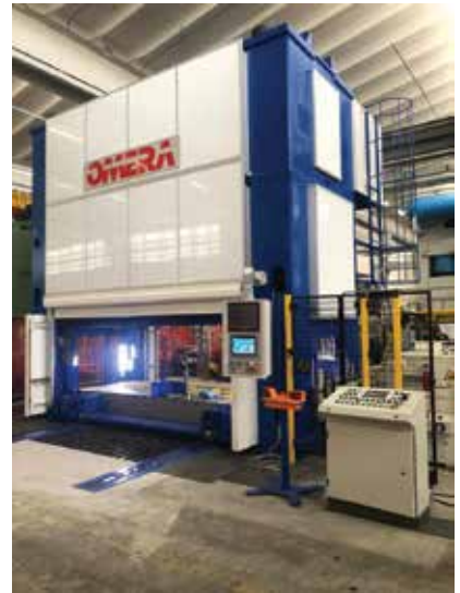
OPM 630R2C2P8 con moving bolster 4000x1500 mm, completa di misuratore di sforzo tranciatura / OPM 630R2C2P8 with moving bolster 4000x1500 mm, with blanking strain meter
